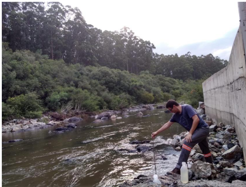
Figura 9 - Coleta de amostra para análise de sólidos em suspensão com o amostrador DH-48. Fonte: Ecossis, 2021.
